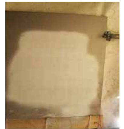
Bijlschrift foto meetopstelling: Door een speciale testopstelling kon met een thermografische camera worden gemeten hoeveel warmte er door de plaat kwam. Hierdoor konden de risico's worden bepaald.
